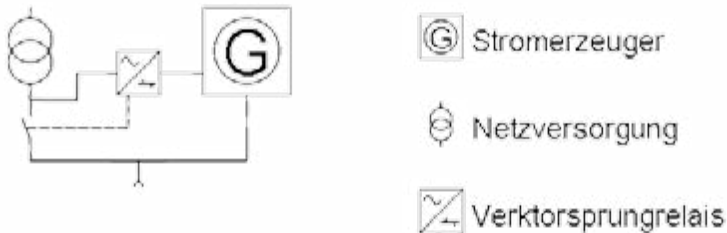
Abb. 5: Umschaltung Netz – Stromerzeuger mittels Vektorsprungrelais
