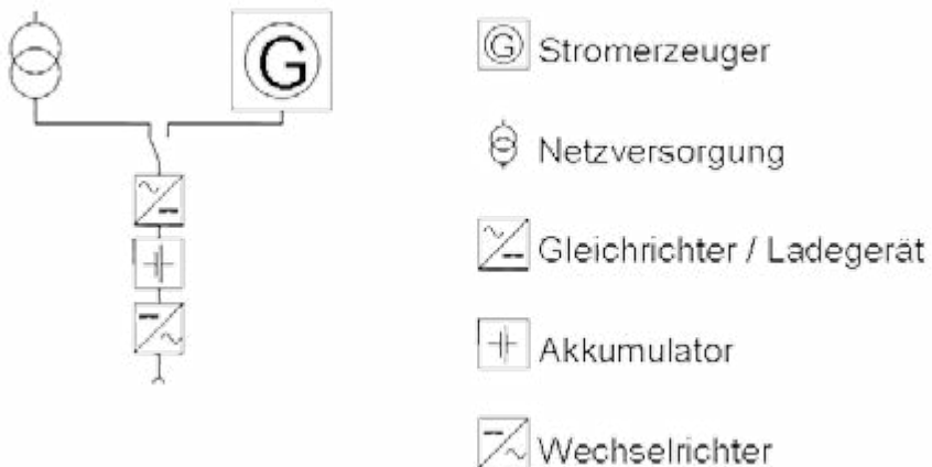
Abb. 4: USV – Anlage mit Stromerzeugerbetrieb
