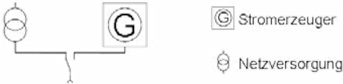
Abb. 3: Umschaltung Netz – Stromerzeuger
