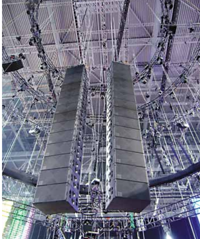
Die beiden 7,5 m langen Linearrays mit je 14 J-Subwoofern
